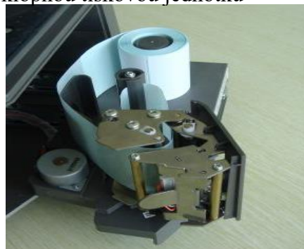
(4) Uvolněný papír vložte do odvíjecího zařízení
