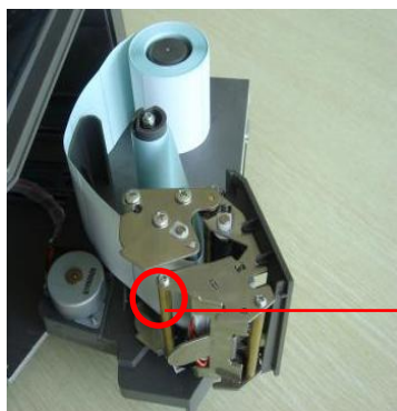
(5) Uvolněný papír navíňte na hřídel odvíjecího zařízení a polohu papíru vymezte stavítkem.
